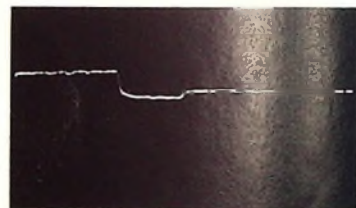
Bild 4. An Stelle einer Durchgangsdose versehentlich eingebaute Enddose
